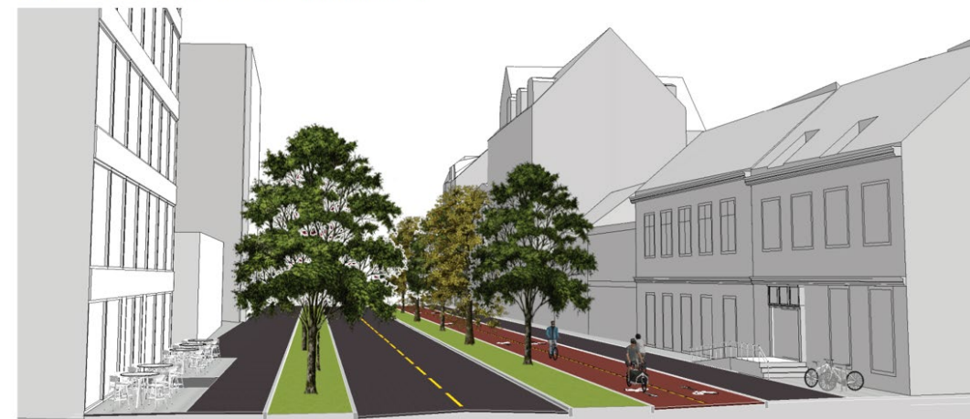
Figur 82. Illustrasjonen viser gatetverrsnitt med brede rabatter der overvann kan ledes fra vegareal til grønne rabatter. Det må vurderes i det enkelte prosjekt om det er aktuelt å tilrettelegge for fordryning i rabatter (illustrasjon: Multiconsult).
