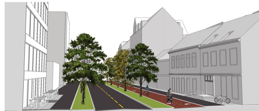
Figur 82. Illustrasjonen viser gatetverrsnitt med brede rabatter der overvann kan ledes fra vegareal til grønne rabatter. Det må vurderes i det enkelte prosjekt om det er aktuelt å tilrettelegge for fordøyning i rabatter (illustrasjon: Multiconsult).
